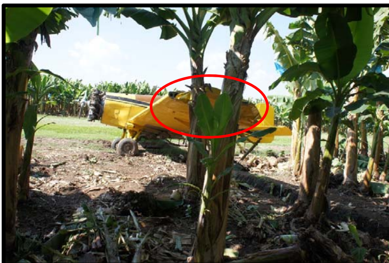
Fotografía No. 5 Punta de ala izquierda dañada al pegar con las plantas de banano.
