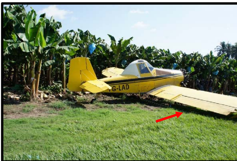
Fotografía No. 4 Ala derecha muy cerca de la superficie, dañando los aspersores.
