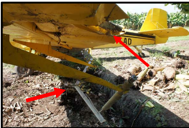
Fotografía No. 12 Vista lateral de ala izquierda con daños en alerón, punta de ala y aspersores.
