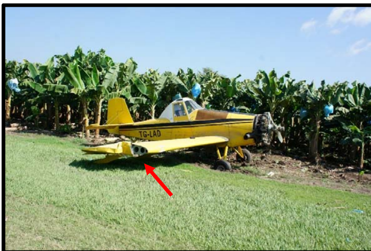
Fotografía No. 3 Punta de ala derecha dañada por impacto.
