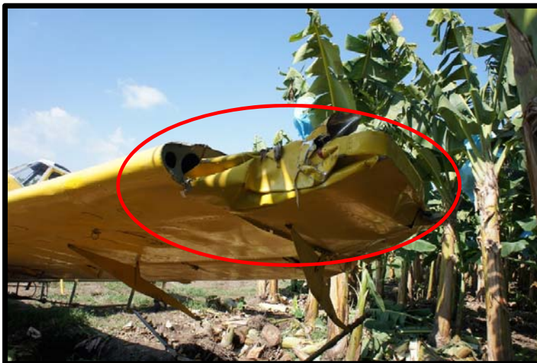
Fotografía No. 9 Vista de Borde de Ataque y punta de ala izquierda dañado.
