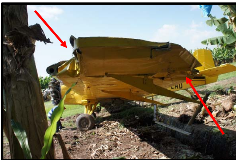
Fotografía No. 10 Vista lateral de punta de ala y alerón dañados ala izquierda.
